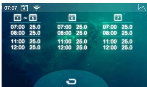
Hier können Sie die Uhrzeit und die entsprechende Temperatur ändern und dann mit der Schaltfläche unten rechts bestätigen.
